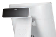
Display Cliente • VFD (2 Linee x 20 Caratteri)
